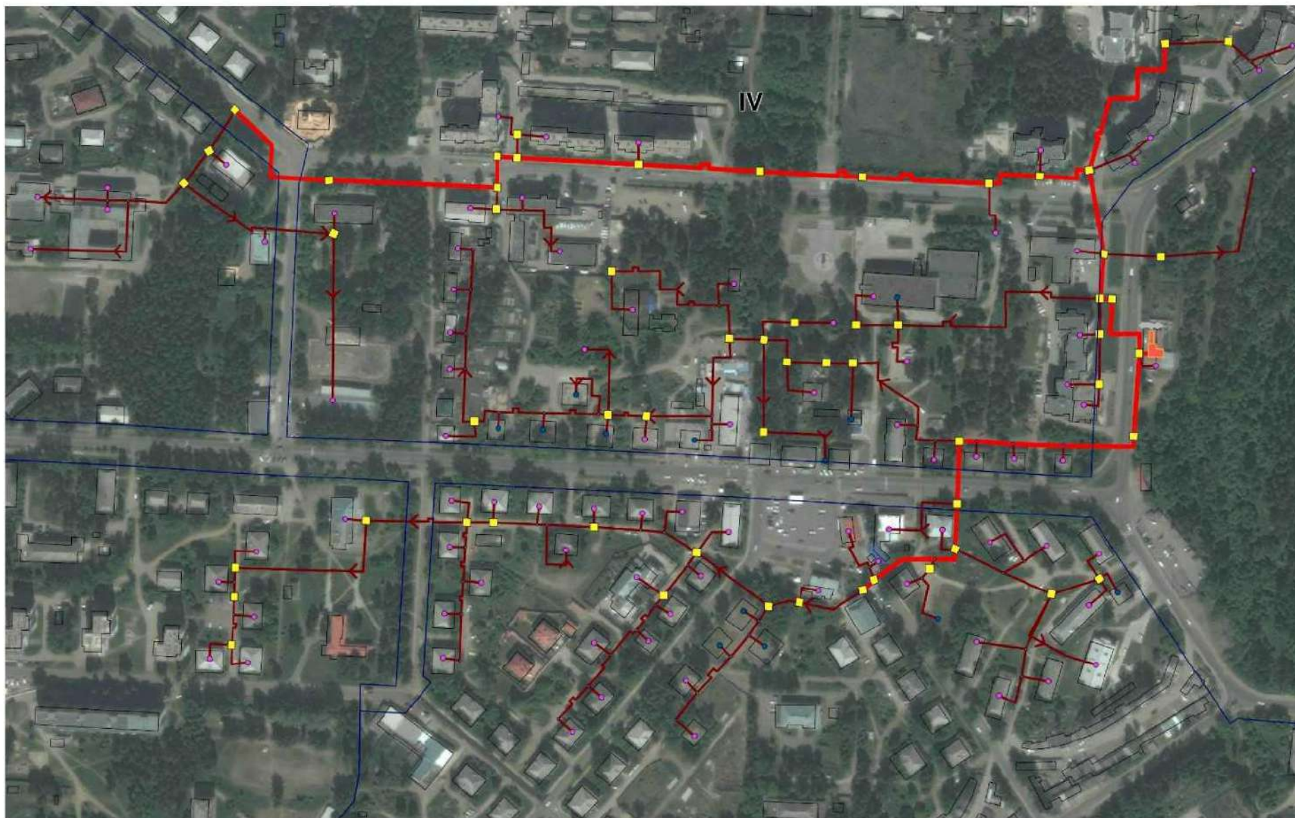
Рисункок1.3.6. Схема тепловой сети от электростанции №14
