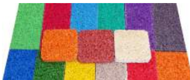
Илл. 1.1.11. ЦВЕТНЫЕ EPDM-ГРАНУЛЫ ДЛЯ ИЗГОТОВЛЕНИЯ РЕЗИНОВОГО ПОКРЫТИЯ
